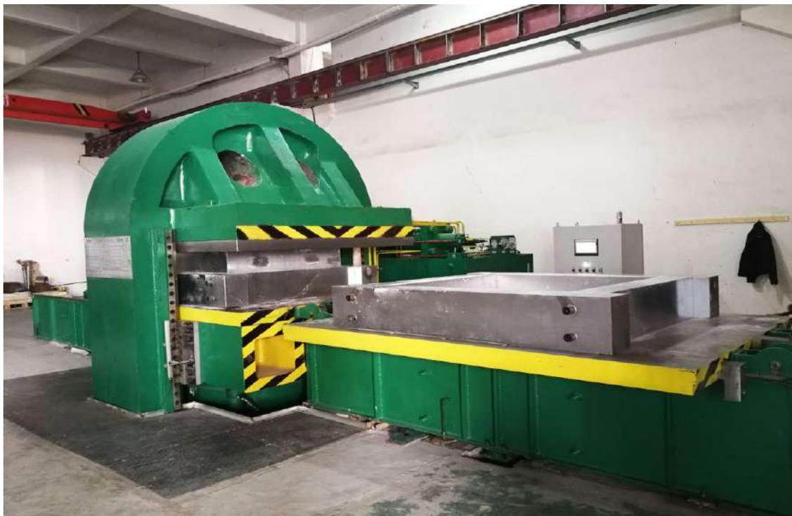
Порошок ПТФЭ прессуется в листы с помощью гидравлического прессы. А затем спекали в термовоздушных печах. Машина в основном используется для прессования порошка, такого как порошок ПТФЭ / тефлона и т. Д. Его также можно использовать для формования больших крышек.
