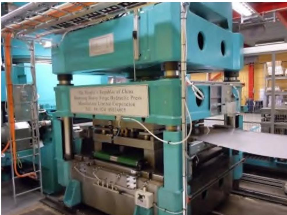
Конструкция пресса - три балки, четыре колонны, цилиндр сверху. Подходит для прессования пластиковых материалов, штамповки, формовки и гибки металлического листа. Он также может быть соединен с листовым гидравлическим прессом YR27 для формирования линии производства пластин теплообменника.
