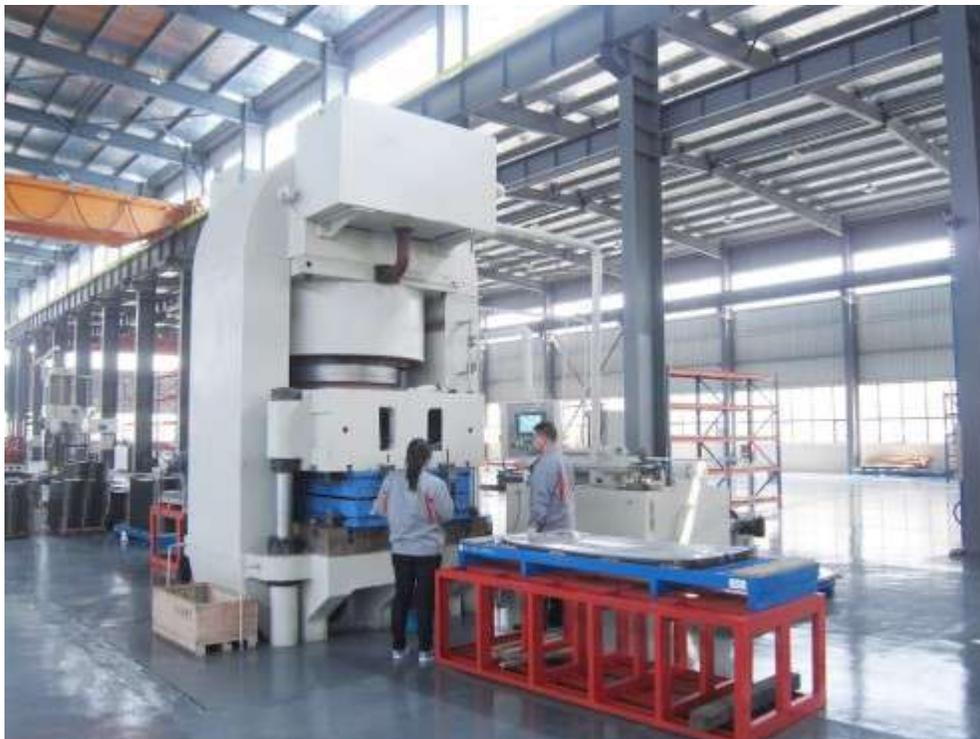
Пресс в основном используется для формования толстолистовой оболочки, такой как титан, нержавеющая сталь, теплообменник и т. д. Он также может быть использован для формирования больших деталей крышки.
