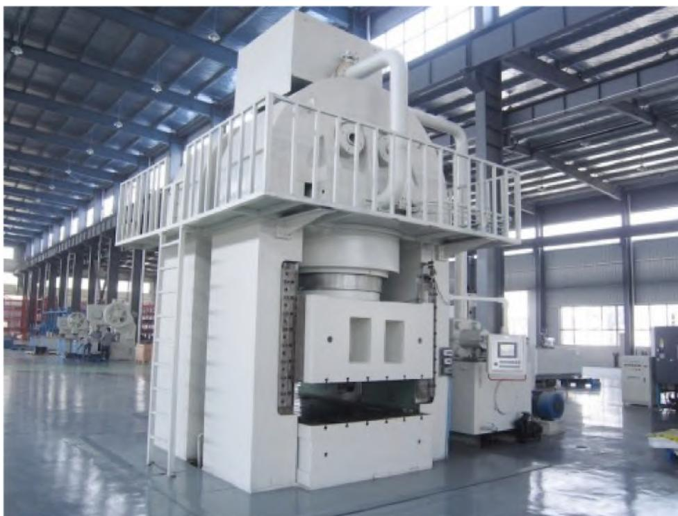
Пресс в основном используется для формования толстолистовой оболочки, такой как титан, нержавеющая сталь, теплообменник и т. д. Он также может быть использован для формирования больших деталей крышки.
