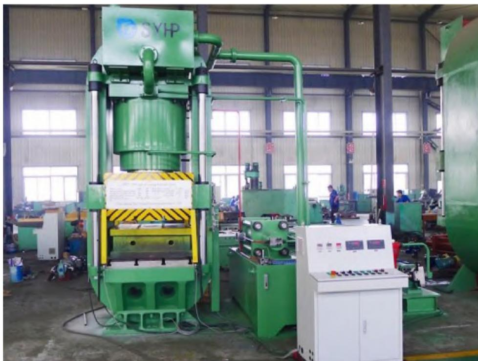
Пресс в основном используется для формования листовой оболочки, такой как титан, нержавеющая сталь и теплообменник, и т. д. Он также может быть использован для формирования больших частей крышки, а также для формирования различных металлов и порошков.
