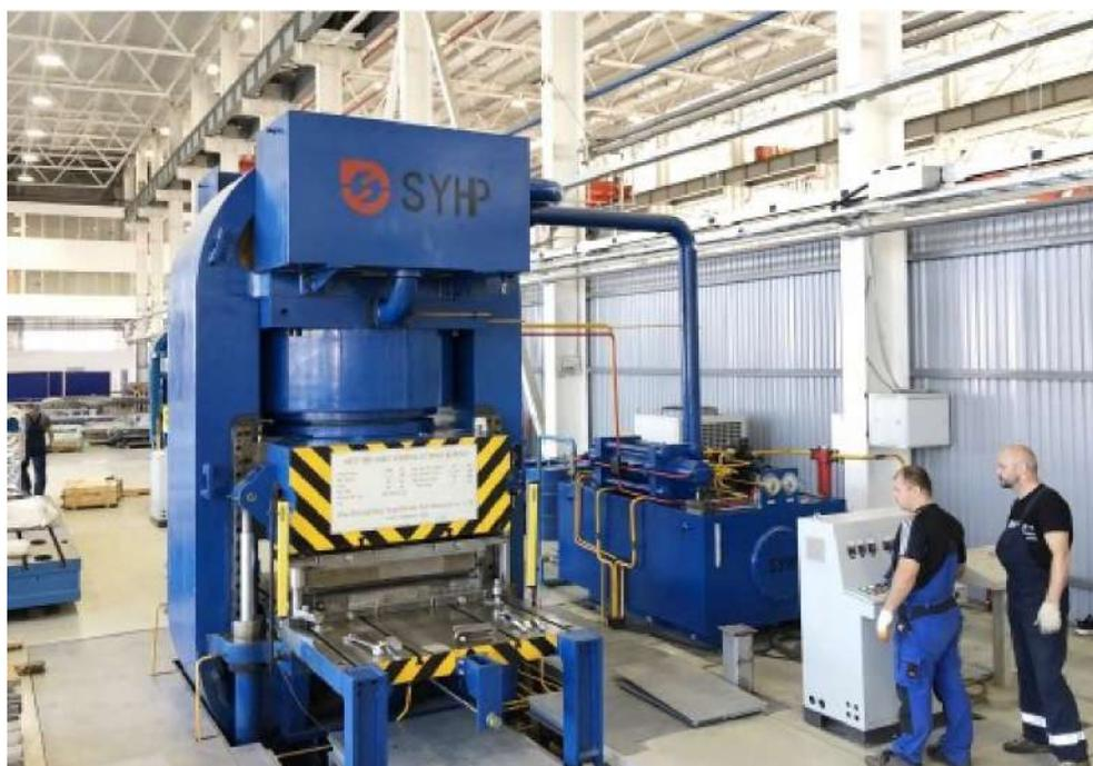
Пресс в основном используется для формования толстолистовой оболочки, такой как титан, нержавеющая сталь, теплообменник и т. д. Он также может быть использован для формирования больших деталей крыши.
