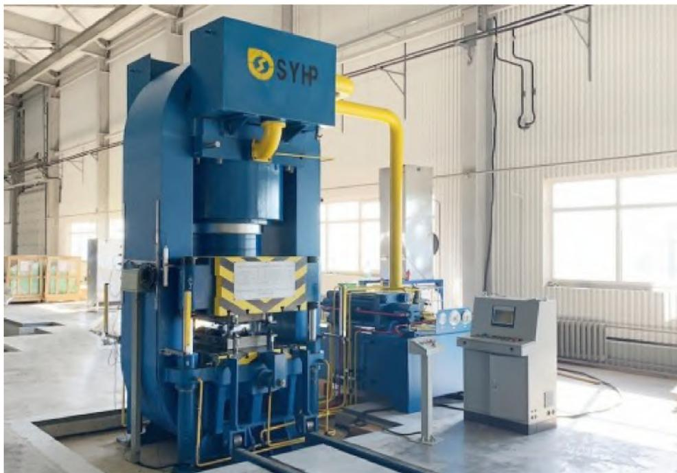
Пресс в основном используется для формования толстолистовой оболочки, такой как титан, нержавеющая сталь, теплообменник и т. д. Он также может быть использован для формования больших деталей крышки.
