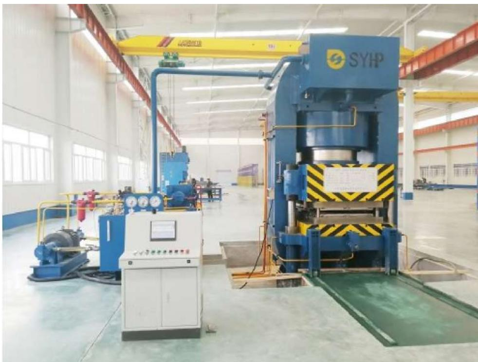
Пресс в основном используется для формования толстолистовой оболочки, такой как титан, нержавеющая сталь, теплообменник и т. д. Он также может быть использован для формирования больших деталей крышки и холодной штамповки.
